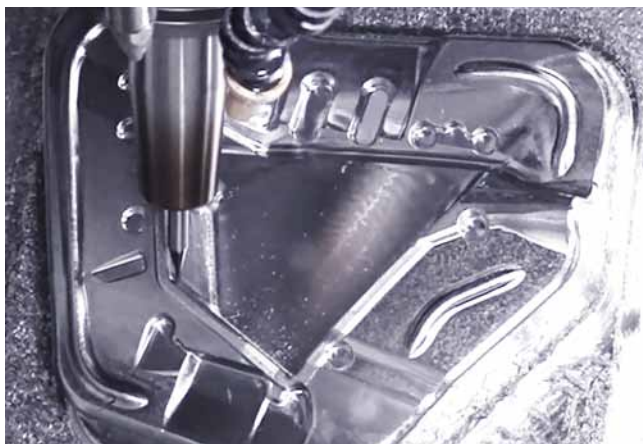
半精加工和经典精加工：带锥颈的整体硬质合金球头立铣刀 MP3XBR，用于深腔的半精加工和精加工。（图片：罗德斯/MMC/特比斯）
