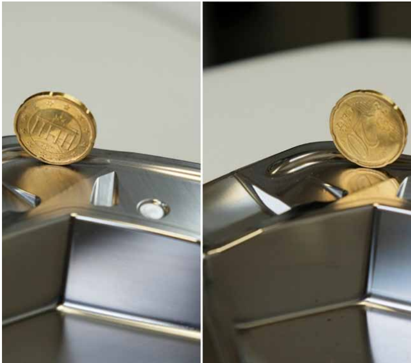
用传统方法铣削的工件（左）与使用现代工具和策略加工的对比件（右）之间的光泽比较（照片：MMC Hartmetall）
