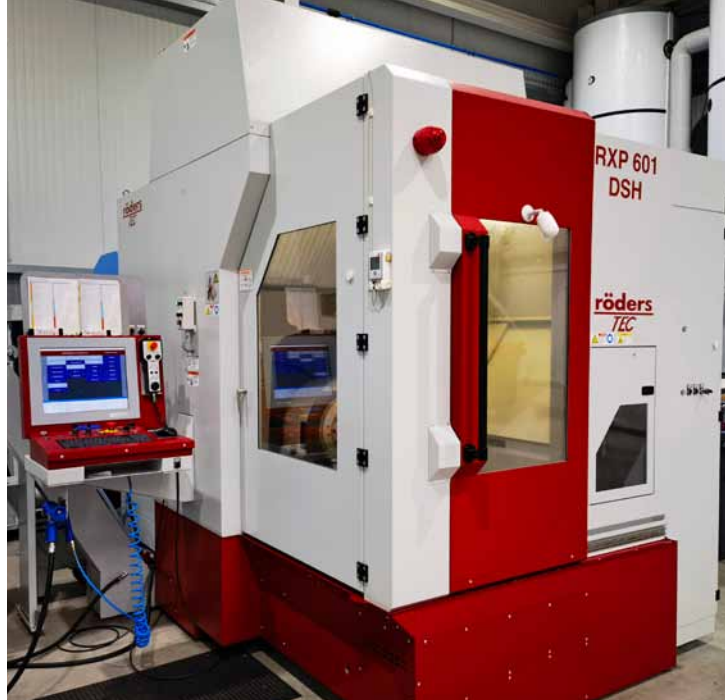
用于加工测试的罗德斯 RXP601DSH 五轴铣削加工中心（图片：Klaus Vollrath）
